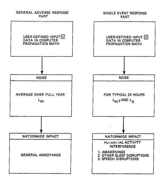
FIGURE 6-9 THE NATIONAL ROADWAY TRAFFIC NOISE EXPOSURE MODEL
